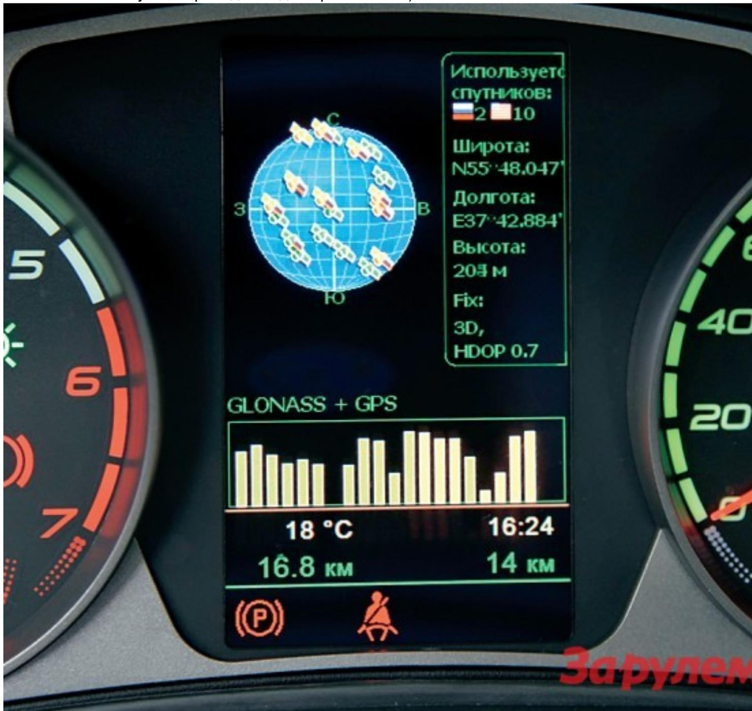
Вазовский навигатор работает и с американскими спутниками GPS, и с российскими ГЛОНАСС – это повышает точность позиционирования. Правда, отечественных спутников в небе до сих пор немного.
