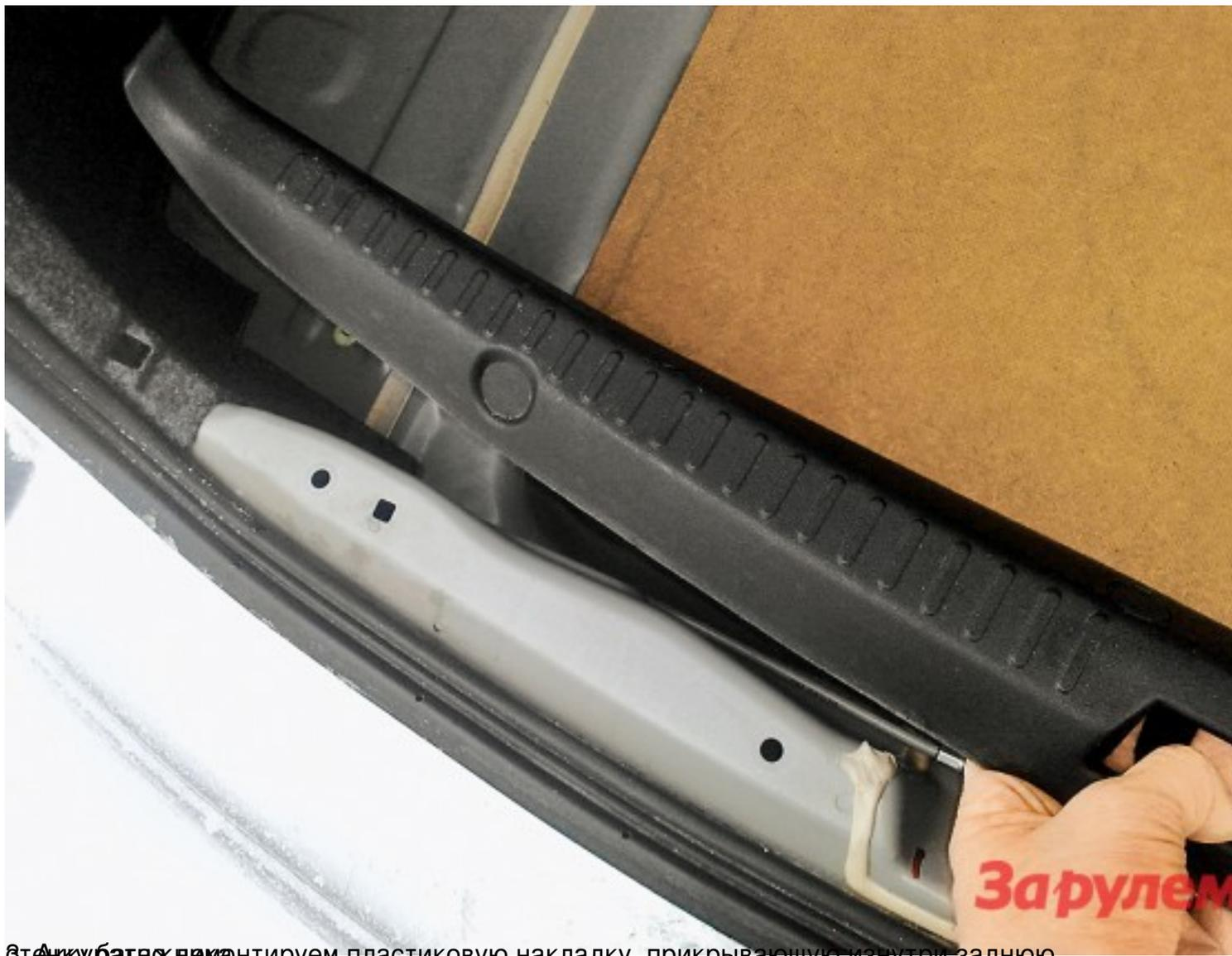
Аккуратно фиксируем пластиковую накладку, прикрывающую изнутри заднюю
