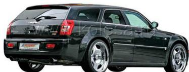
В роли "больших колес" выступила четверка 22-дюймовых ободов, "обутых" в резину размерностью 265/35 R22. К осени в GeigerCars появятся и 24-дюймовые диски, но молодость не любит ждать... Пружины извлекли, заменив их новыми, опустившими кузов на 50 мм. А из внешних доработок вариантов выбор был невелик: от стандартной радиаторной решетки отказались в пользу новой, хромированной.
